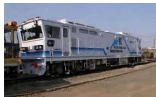
小田急電鉄 探傷車 2003年 国内のレール探傷車の約7割は東京計器・レールテクノ製
