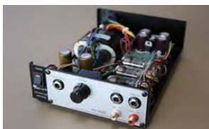
真空管を用いたヘッドホンアンプ(現在製造販売中)
